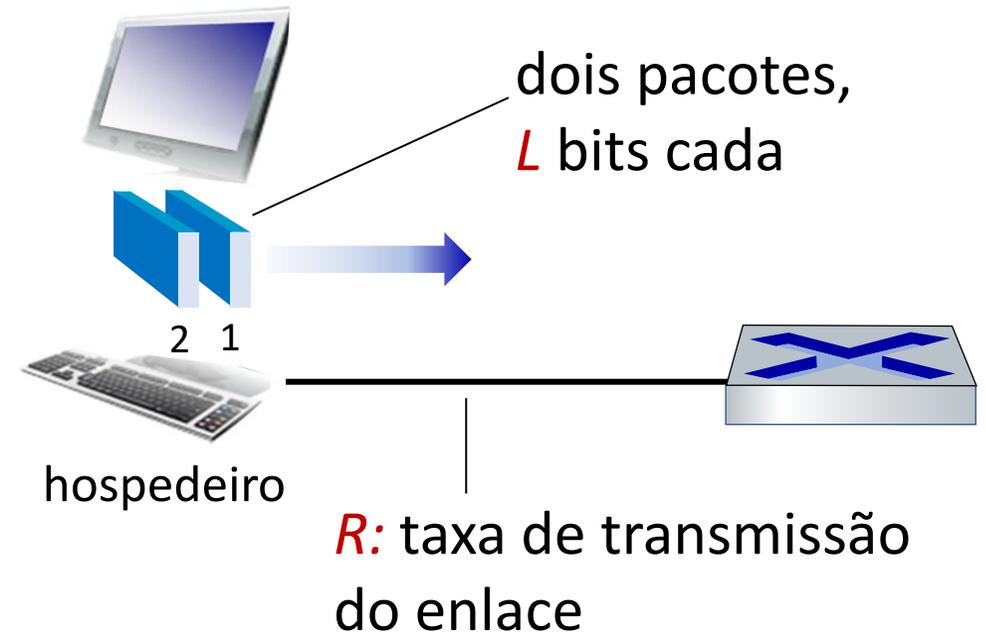
$$\text{atraso na transmissão do pacote} = \text{tempo necessário para transmitir o pacote de } L\text{-bits no enlace} = \frac{L \text{ (bits)}}{R \text{ (bits/s)}}$$
