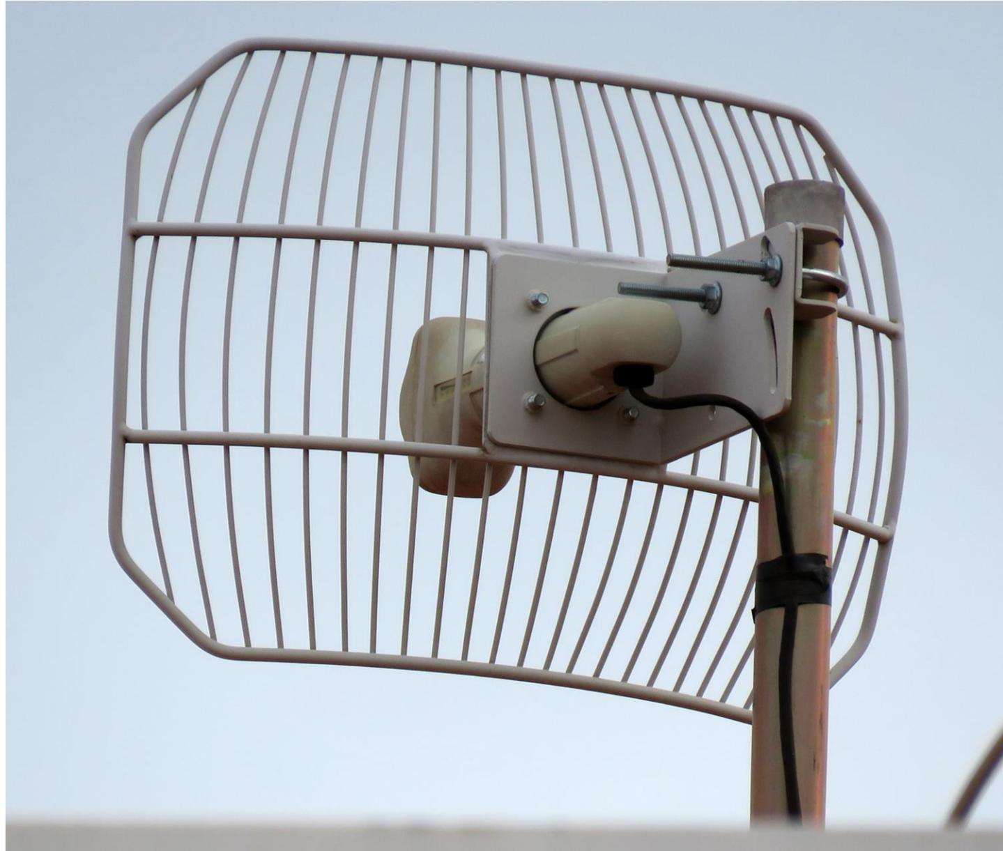
Rádio WiFi acoplado diretamente na Antena Externa e Cabo Ethernet PoE (*Power over Ethernet*)
