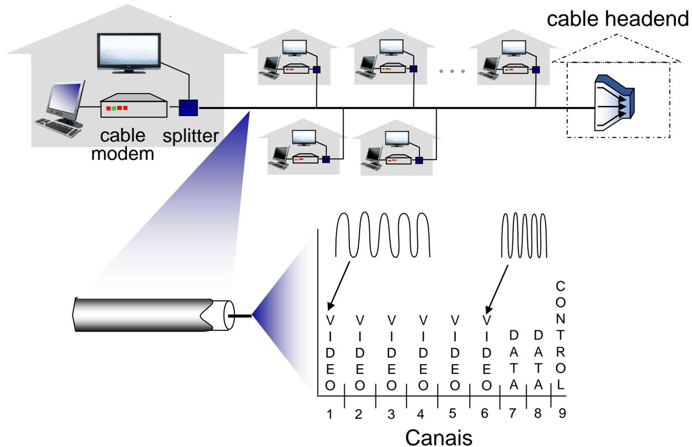
*multiplexação por divisão de frequência (frequency division multiplexing - FDM):* diferentes canais transmitidos em diferentes bandas de frequência
