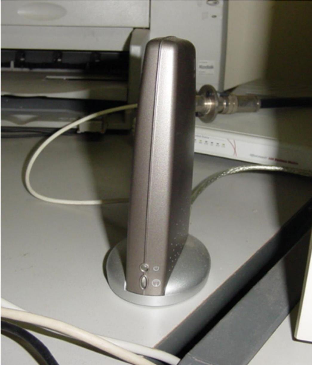
Rádio WiFi Externo USB, com *pigtail* para conexão de antena externa
